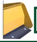
SIDE PLATES EXTEND TO CONTAIN SOIL WHEN BACK-FILLING
